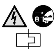
モータ内部に過負荷保護装置のサーマルプロテクターが内蔵されています。(但し、単相100V、単相200V、三相200Vの日本標準仕様のみ内蔵) サーマルプロテクターが動作した場合は、すぐに本機の元電源を切ってください。(保護装置による電源の遮断が望ましいです。) サーマルプロテクターはモータが過負荷運転となった時、モータ内部温度が上昇(約120°C前後)すると、自動的に働いてモータの運転を停止させます。また、停止後モータ内部の温度が低下(約80°C前後)すると、サーマルプロテクターは自動的に復帰(接点が導通)します。電源が投入されたままの状態では復帰と同時にモータの運転が再開されますので、電源が投入された状態のままで突然モータの運転が再開され予期せぬ事故の発生原因となるおそれがあり大変危険です。自動復帰による事故防止の為、必ず本機の元電源を切ってください。尚、サーマルプロテクターが動作した原因を究明・除去するまでは、運転を再開させないでください。
