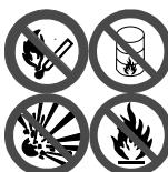
本機は乾いた一般粉塵捕集用の集塵機です。火気および爆発性の粉塵・含塵液体液霧は絶対に吸引させないでください。火災事故等防止のため、引火性のもの、爆発性のもの、火花を含んだもの、火のついたもの(火種、タバコ等)、可燃性のもの、引火性・可燃性・爆発性物質等が付着したものの吸引は禁止です。また液体液霧に対しても同等禁止事項です。
