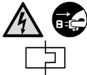
サーマルプロテクターが動作した場合は、すぐに本機の前電源を切ってください。(保護装置による電源の遮断が望ましいです。)
